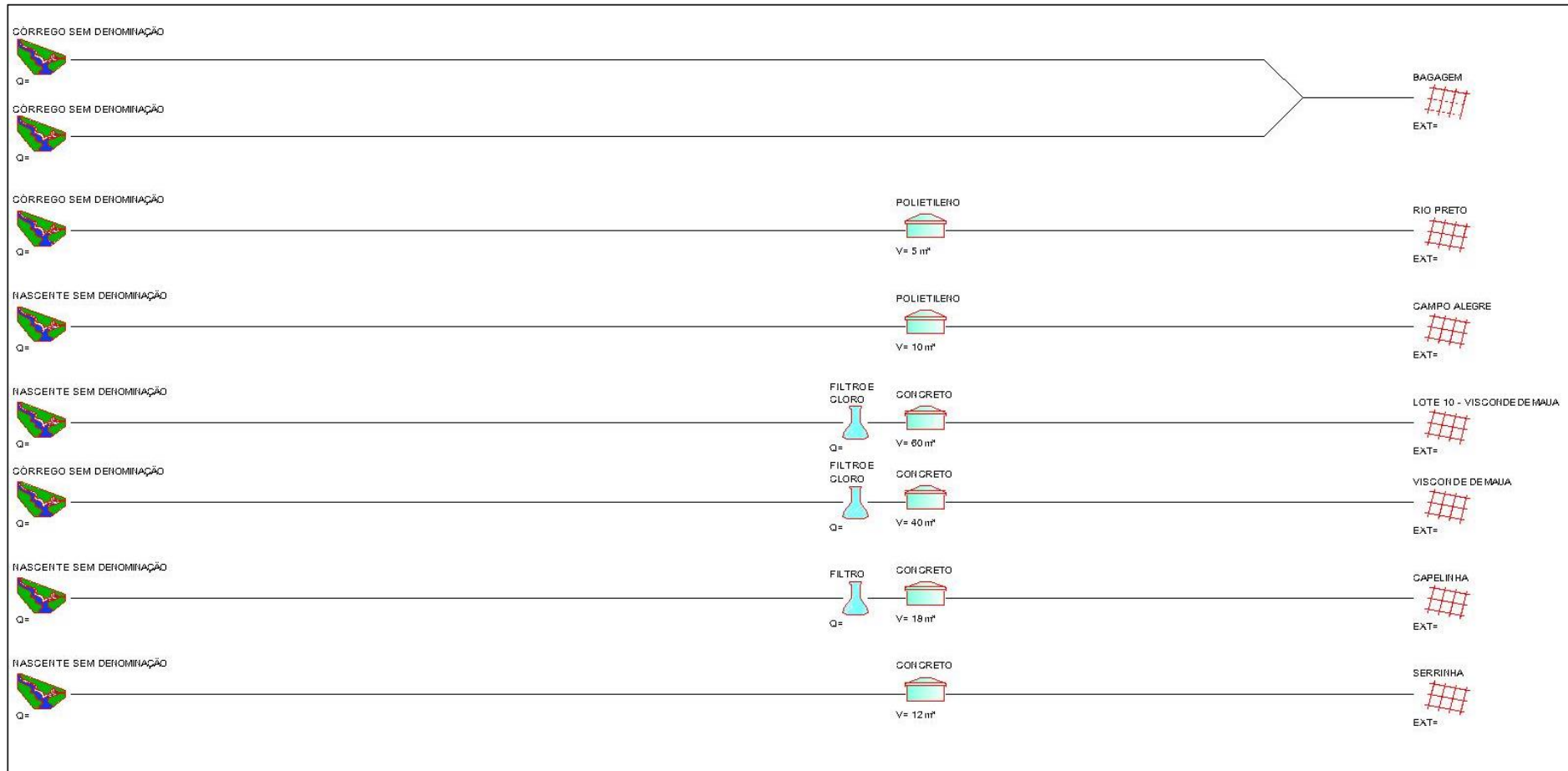
Figura 40 – Esquema dos sistemas de abastecimento de água das localidades
